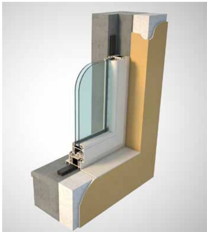
Pose en feuillure
